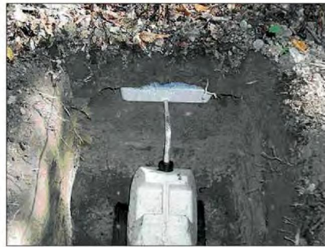
Slika 9. Protočni površinski lizimetri na pokusim plohamama u šumskom ekosustavu
