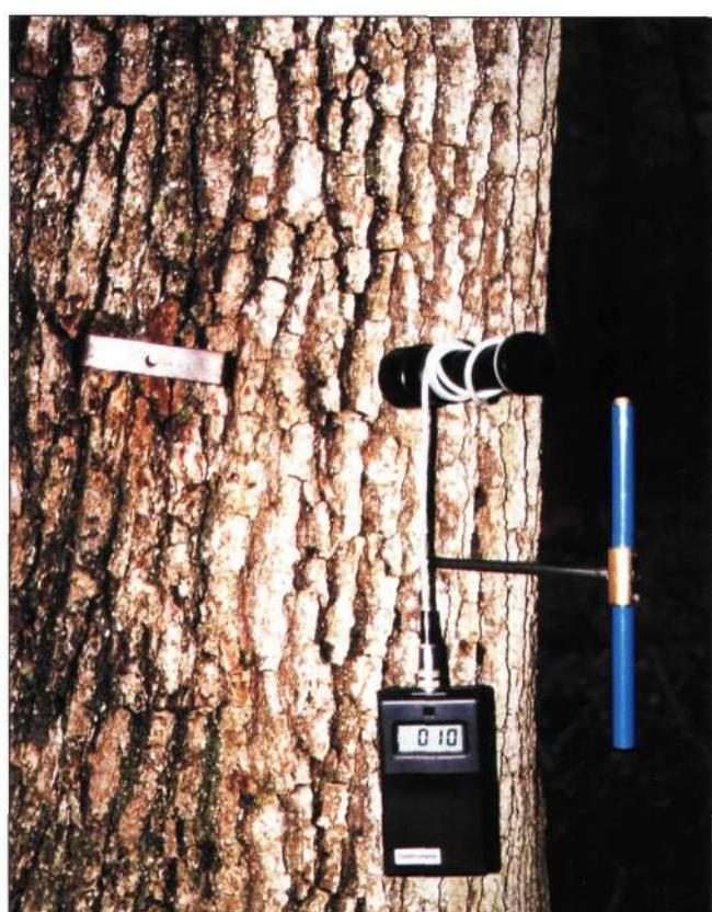
Foto 4. mjerjenje električnog otpora kambijalne zone
