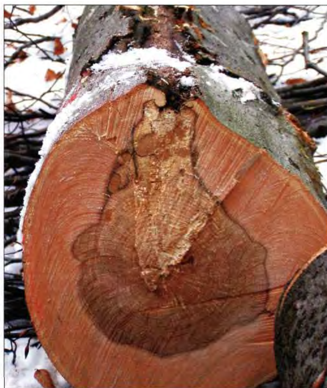
Slika 4. Nepravu srž bukve kod oštećenih stabala Figure 4 False heartwood of damaged beech trees
