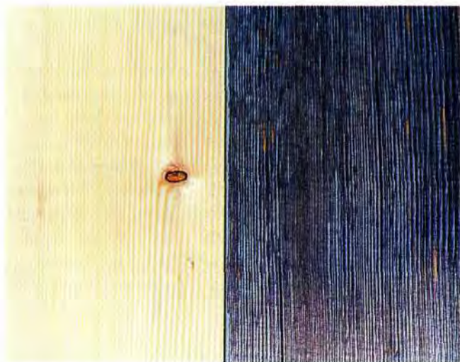
Slika 2. Površina jelovine prije i nakon osam mjeseci prirodnog izlaganja u kontinentalnim uvjetima (Zagreb, Hrvatska, 45 ° prema jugu, od siječnja do kolovoza 1997). Vidljiva je promjena boje, velik broj površinskih pukotina te erozija koja je intenzivnija na zonama ranog drva.
