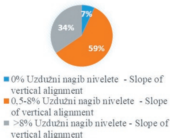
Grafikon 1. Udjeli grupa uzdužnog nagiba nivelete, % Graph 1. Share of groups of slope of vertical alignment, %
