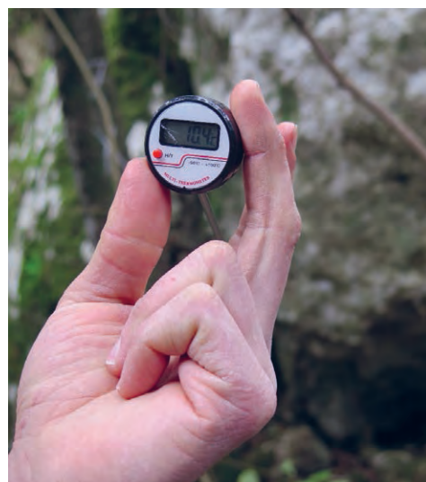
Slika 15. Multitermometer korišten u istraživanjima na području posebnog rezervata šumske vegetacije Kočje (Foto: Autori)
