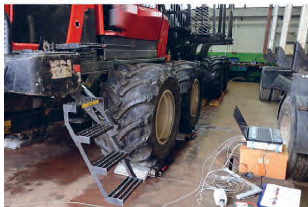
Slika 4. Utvrđivanje točke težišta forvardera
