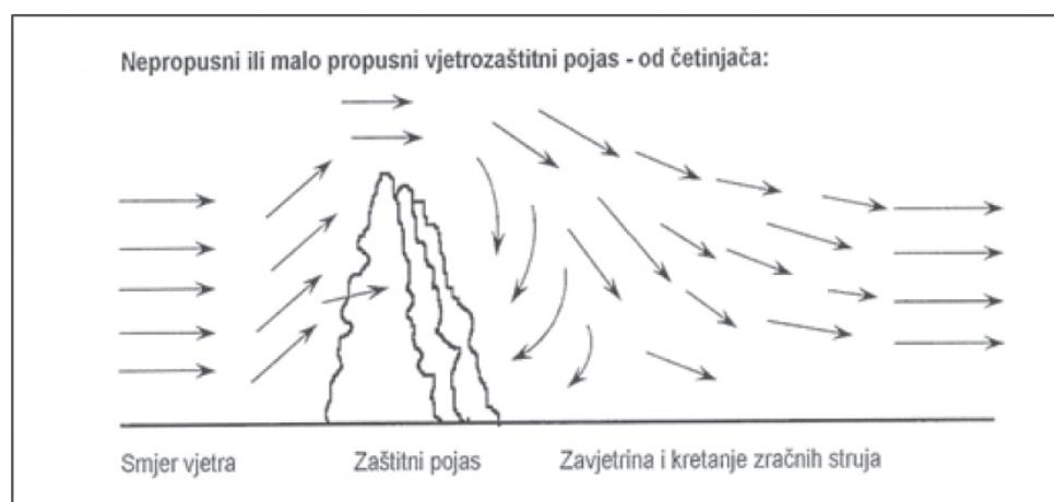
**Slika 3.** Prikaz nepropusnog ili slabo propusnog pojasa od četinjača
