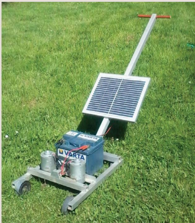
Foto. 2: Kosičica sa solarnim panelom za obnovu struje u akumulatoru
