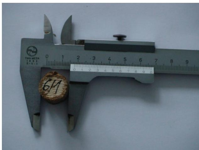
**Slika 10.** Stereometrijsko određivanje obujma uzorka
