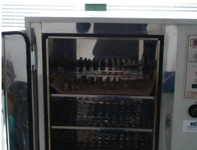
**Slika 12.** Sušenje uzorka u sušioniku
