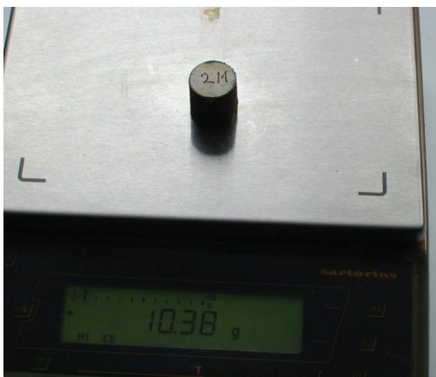
**Slika 11.** Mjerenje mase uzorka
