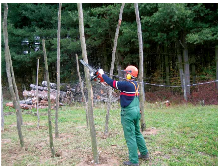
Slika 4: Mjerenje vibracija pri rezanju u simuliranim uvjetima
