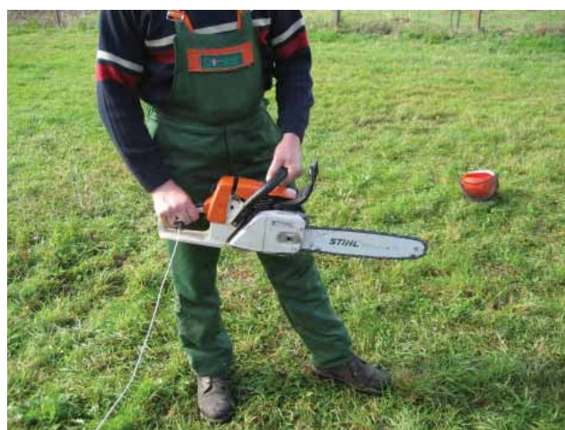
Slika 3: Neke aktivnosti rukovanja pilom u praznome hodu a) prenošnje pile lijevom rukom – stražnja ručka b) prenošnje pile desnom rukom – stražnja ručka c) prenošnje pile lijevom rukom – prednja ručka d) prenošnje pile s obje ruke
