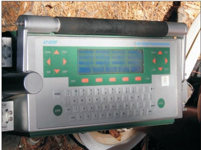
Slika 2. Infrared Gas Analyzer (IRGA): Li-Cor 6400
