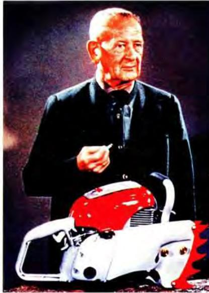
Slika 1: Osnivač firme Andreas Stihl, 1896. godište, sa legendarnom pilom Stihl Contra. Mašina je bez osovine sa centrifugalnom spojkom, snage 6 KS i masom od 12 kg. Masa je utjecala na svjetski proboj motorne pile, krajem pedesetih godina.
