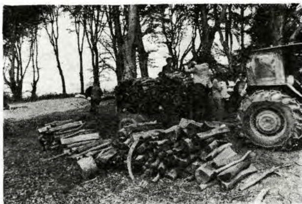
Sl. 6 — Poluprikolica za paketiranje kraj panja za 2 svežnja od po 1,0 prm. Izrađena u radionici gospodarstva. Prikaz rada za stručnjake gospodarstva u sastojini tuturina g. j. Pakračka gora lipnja 1975. god. (Foto Čuković)
