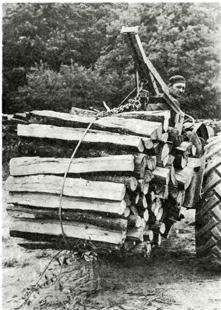
Sl. 2 — Traktor IMT-558 sa pristupnom nosivom daskom izrađenoj u radionici gospodarstva nosi teret od 1,00 prm (Foto Lacković)
