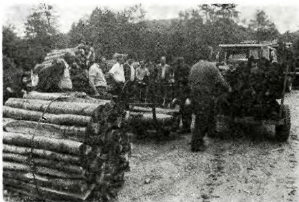
Sl. 7 — Ručni istovar prikolice bez kiper uređaja u okvir za paketiranje na pom. stovarištu. Vidi se svežanj od 1,0 prm povezan jednim vezivom od golog čeličnog užeta. Prikaz rada za stručnjake gospodarstva (Foto Čuković)
