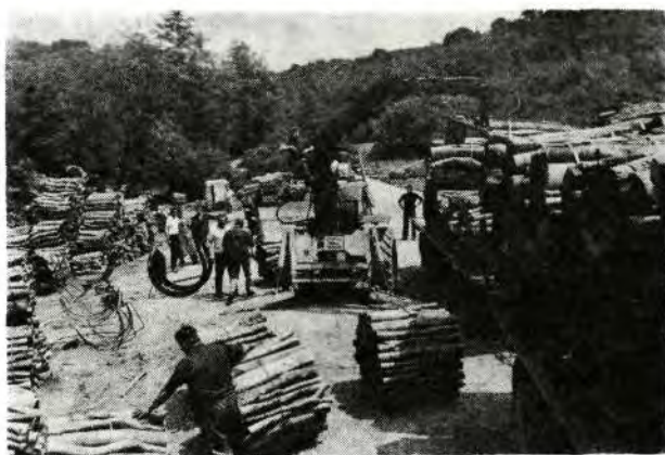
Sl. 8 — Utovar svežnjeva u kamione sa prikolicom. Grajfer (hvatač) izrađen po »Tehnoprojektu« Vinkovci (Foto Čuković)
