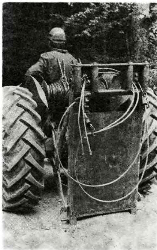
Sl. 3 — Traktor IMT-558 sa nosivom daskom izrađenoj u radionici gospodarstva i dvobubanjским »Igland« vitlom (Foto Lacković)
