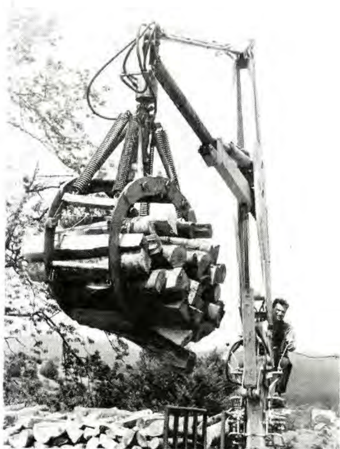
»Hvatač« i »okretač« u radu na utovaru prostornog drva u Šumariji Vrbovsko
