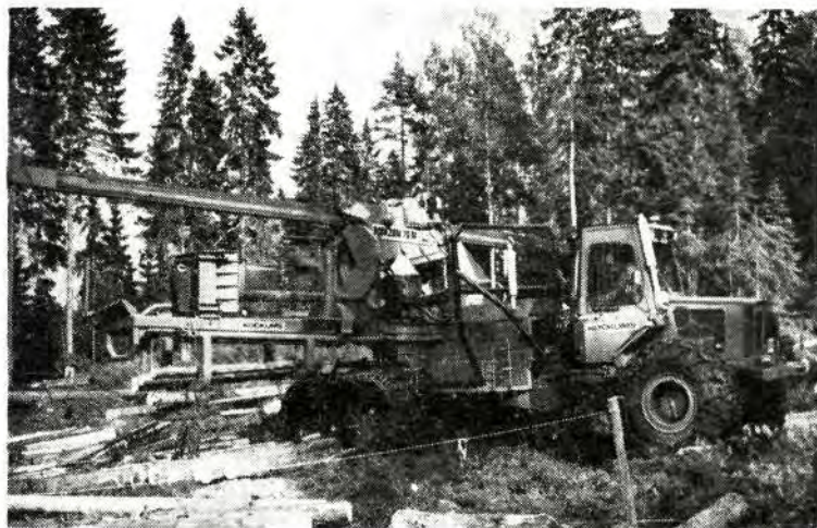
Sl. 1. PROCESSOR — stroj za obaranje, kresanje, trupljenje i sortiranje
