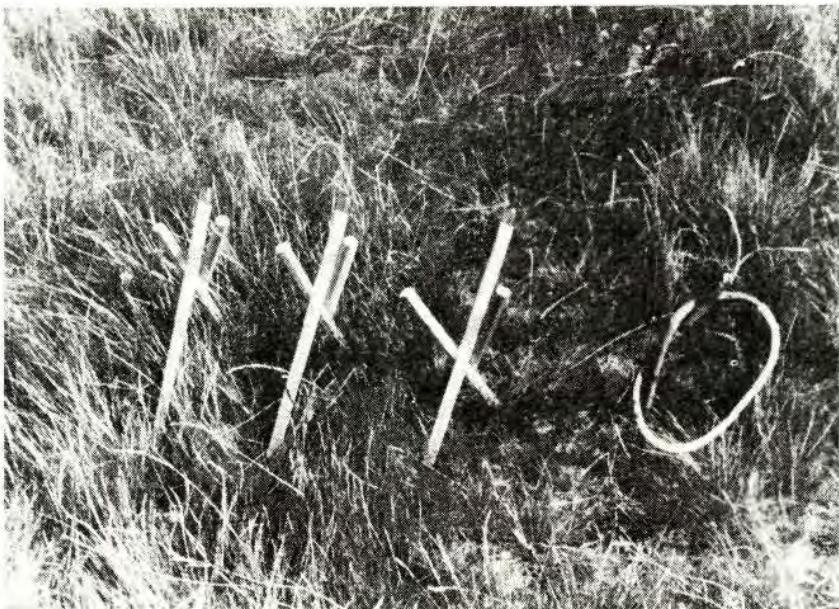
Sl. 2 — Termometri za mjerjenje temperature tla
