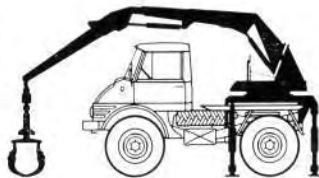
Unimog sa zahvatnom dizalicom. Istovar do daljine 5 m.
