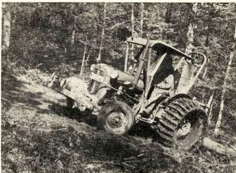
Sl. 3. Na teškim terenima traktor si pomaže vitlom. Skinute postrane stijene (Original)
