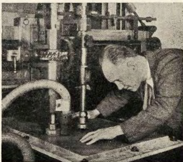
Sl. 7. Stroj za ispitivanje habanja drveta (Wood, June 1952)
