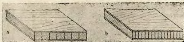
Sl. 2. Krupno šperovano drvo (panel ploče)
